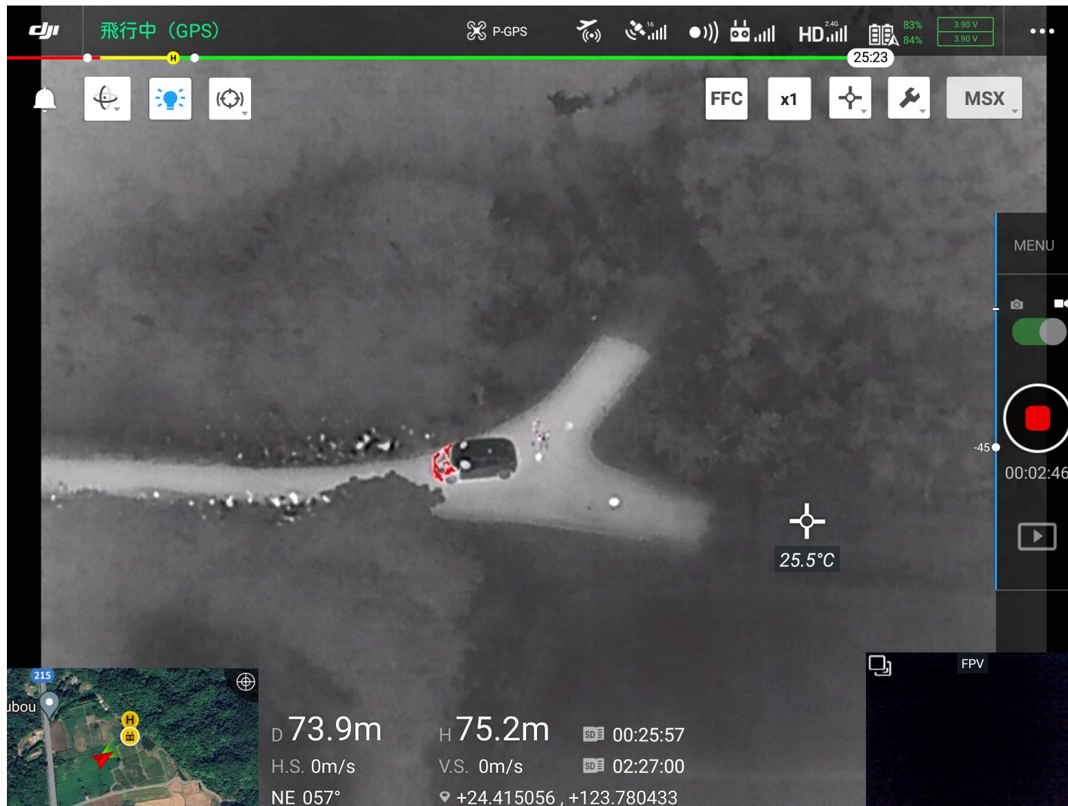
熱赤外線カメラで得られた乗用車ボンネットの熱反応画像例 (2024年04月23日夜明け前(05時30分頃)撮影)
