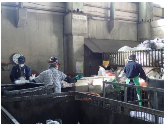
写真 1.14 容器プラ類手選別ヤード
