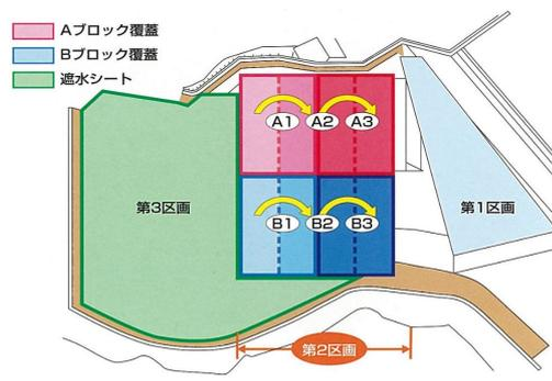
● テント式の覆蓋を2基設置し、順次移動させながら作業を進める。
