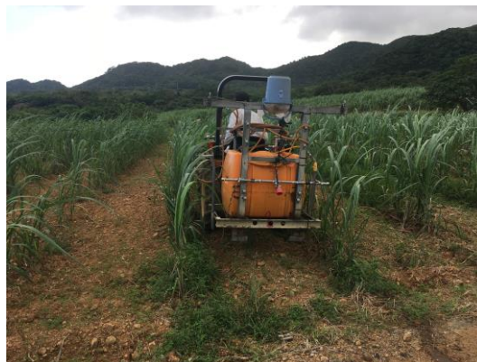
図 2-7-7：さとうきび畑にブルトラで液肥を散布する様子
