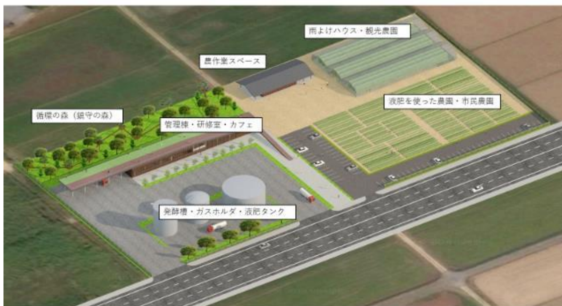
図 2-12-15：前処理施設を別の場所に設置した場合の施設構成のイメージ 2
