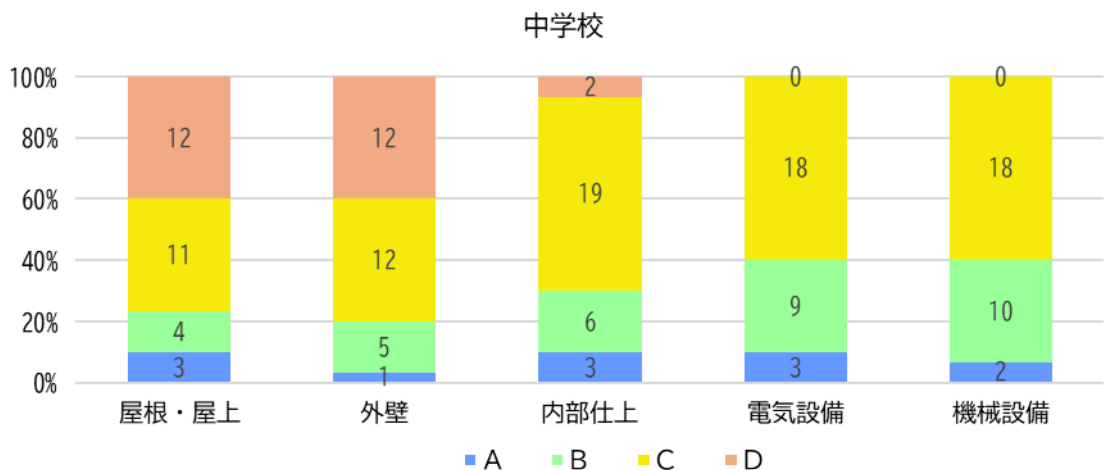
図2-9. 中学校の劣化状況調査結果
