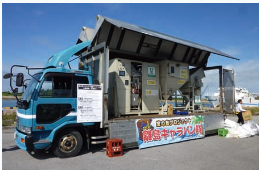
▲発泡スチロールの油化プラント（移動式）
